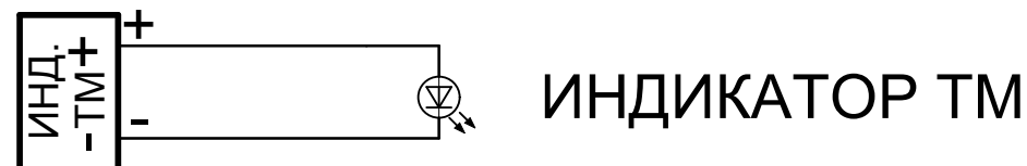
Рисунок 12. Схема включения индикатора считывателя ТМ
