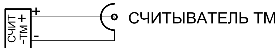
Рисунок 11. Схема включения считывателя для ТМ
